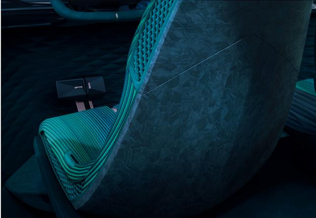
**Bild 1.** Das Leichtbaudesign der Sitzlehnen soll das Gewicht des Konzeptfahrzeugs ENO.146 reduzieren. Im Vergleich zu bisherigen Lehnen ist die Entwicklung aus Polycarbonat um bis zu 50 % leichter © GAC
