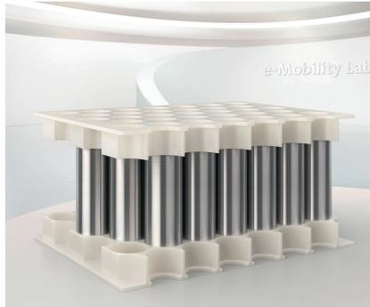
**Bild 3.** Die zylindrischen Zellen können in nur 5 s in dem Träger aus einem PC+ABS-Blend verklebt werden © Henkel, PR082
